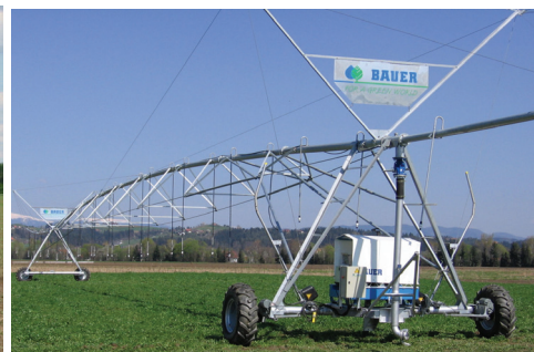
MONOSTAR - para áreas rectangulares com mudança de faixa de rega.
